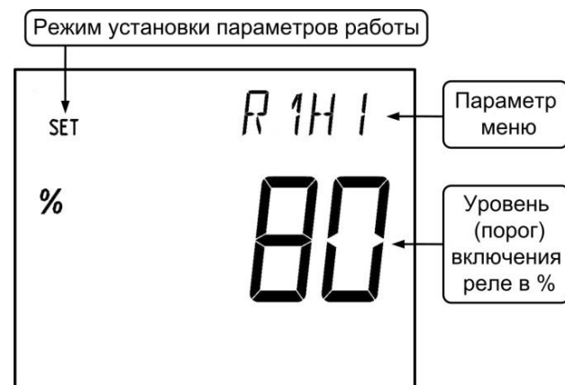
Рисунок 1 – Назначение отображаемых элементов дисплея в режиме настройки (программирования) параметров работы (R1HI – установка уровня сигнала для включения контактов SW1 реле)
